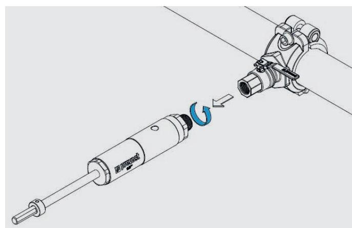
Sujete le herramienta **PPS DRIL**. Desatornille.
