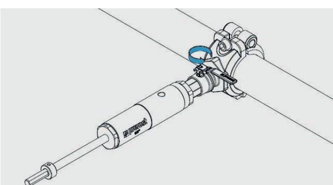
Desatornille la herramienta de perforación **PPS DRIL**.
