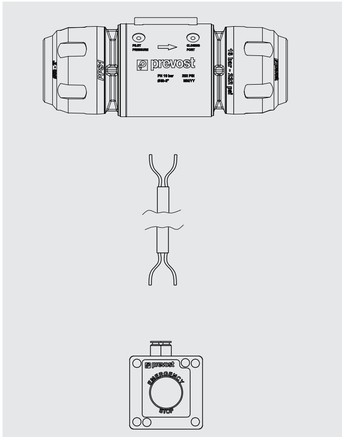
Realicen la unión entre la válvula neumática y el control remoto conectando los 2 tubos PA Ø 0.15" respetando los indicadores "PILOT PRESSURE" y "CLOSING PORT" señalados en cada uno de los productos.
