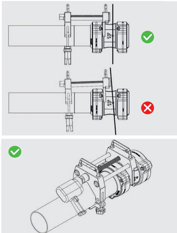
Durante el apriete, mantenga el racor en posición en el extremo del tubo
