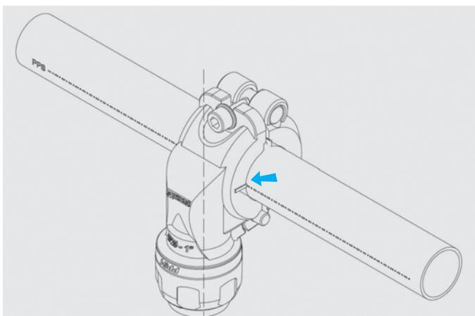
Ajuste la brida de derivación en la posición deseada utilizando el doble marcado en el tubo.
