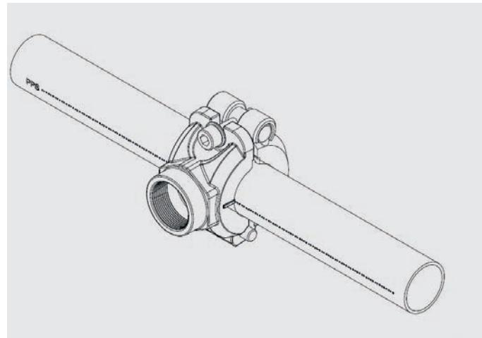
Ajuste la brida de derivación en la posición deseada utilizando el doble marcado en el tubo.
